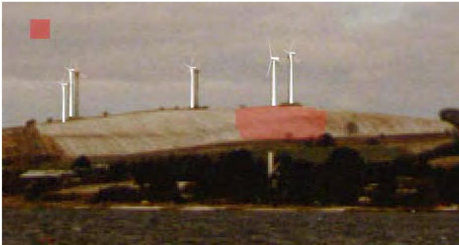
*Figura 5 La herramienta goma simplemente “pinta” las áreas borradas, dónde Ud. no desea renderizar. De este modo puede borrar una montaña entera, de modo que incluso si mueve ligeramente los AGs que han de renderizarse detrás de la montaña no serán visibles aquellas partes que queden delante de la montaña.*
