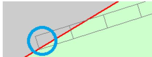
Dies kann leider nicht automatisch behoben werden. Sie können dazu den Rand der PV-Fläche anpassen oder eine Ausschlussfläche einfügen, um das zu vermeiden.
