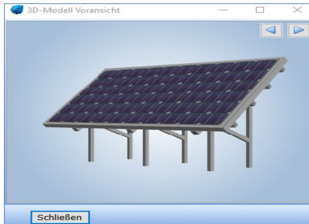
Allerdings sind das Modul und die Unterkonstruktion zwei unterschiedliche Komponenten und können nicht gleichmäßig skaliert werden, d.h. etwas manuelle Anpassung wird hier erforderlich.
