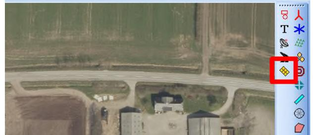
Setzen Sie das Solar-PV-Objekt in die Nähe des Gebiets, in dem Sie die PV-Anlage planen. Die genaue Position des Objekts ist dabei nicht relevant. Sobald das Objekt gesetzt ist und Sie auf **OK** klicken, ist der Bearbeitungsmodus zur Erstellung einer neuen PV-Fläche aktiviert und Sie können sofort per Linksklick Ihre geplante PV-Fläche auf der Karte digitalisieren.
