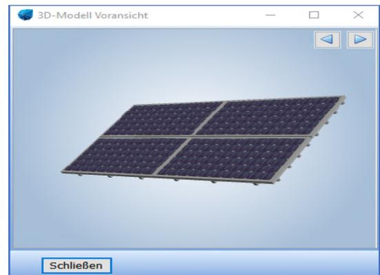
Diese zusammenhängenden Tische werden nun verwendet, um die digitalisierte PV-Fläche zu füllen. Je größer dabei die Tische sind, umso kleiner ist die Anzahl der Tische pro Fläche.
