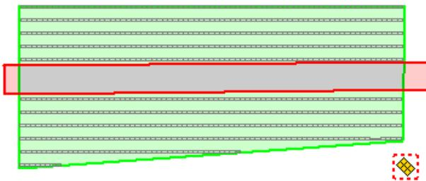
Im selben Solar-PV-Objekt können mehrere PV-Flächen und Ausschlussflächen angelegt werden. Die Liste der erstellten Flächen wird im Statusfenster angezeigt, wenn das Solar-PV-Objekt eingefügt wird:
