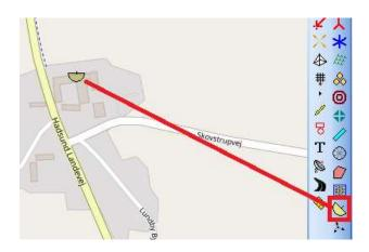
Ein Schatten-/Blendungsrezeptor kann zur Berechnung des Schattenwurfs von Windenergieanlagen und Blendung durch PV-Module und 3D-Objekte verwendet werden. Standardmäßig ist der Schatten-/Blendungsrezeptor so eingestellt, dass er in der SHADOW-Berechnung verwendet wird. Um das Objekt in einer GLARE-Berechnung zu nutzen, müssen Sie im Objekt-Setup ein Kontrollkästchen auf Register Blendung aktivieren und die erforderlichen Eingaben anpassen:
