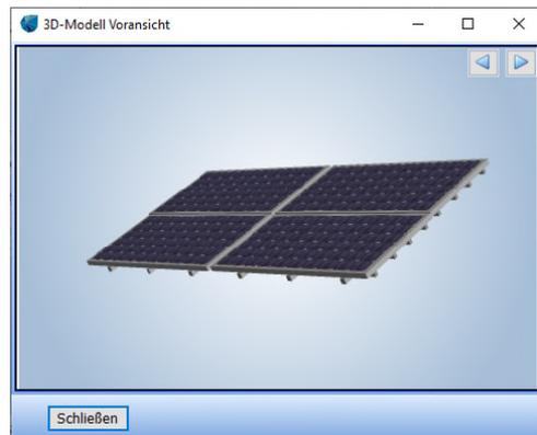
Diese zusammenhängenden Tische werden nun verwendet, um die PV-Fläche zu füllen. Je mehr Module vertikal übereinander platziert werden, desto größer müssen die Reihenabstände gewählt werden.
