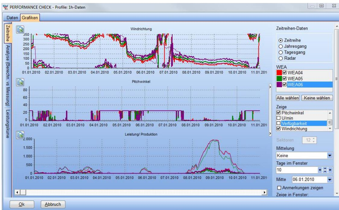
Sind real gemessene und berechnete Werte vorhanden, werden die realen Daten als dicke, die berechneten als dünne Linie gezeigt. Häufig stammen die Winddaten aus der Messung auf der Gondel und sind durch den Rotor beeinflusst sowie durch die verwendeten Geräte und Ungenauigkeit beim Aufbau (z.B. Einnorden der Windfahne) nicht zuverlässig. Rechts unten neben der Grafik kann daher ausgewählt werden, dass die Windrichtung nur aus den berechneten Daten verwendet wird.
